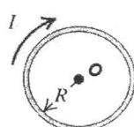
i smera kao na slici, postoji magnetno polje intenziteta  $H = 5 \frac{A}{m}$ . Izračunati intenzitet struje  $I$  naznačiti smer vektora magnetnog polja na slici.
