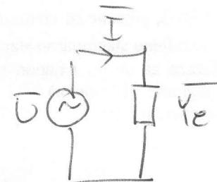
$$\bar{Y}_e = \bar{Y}_C + \bar{Y}_L + \bar{Y}_R = -j0,1 + j0,1 + 0,1 = 0,1 \text{ S}$$
