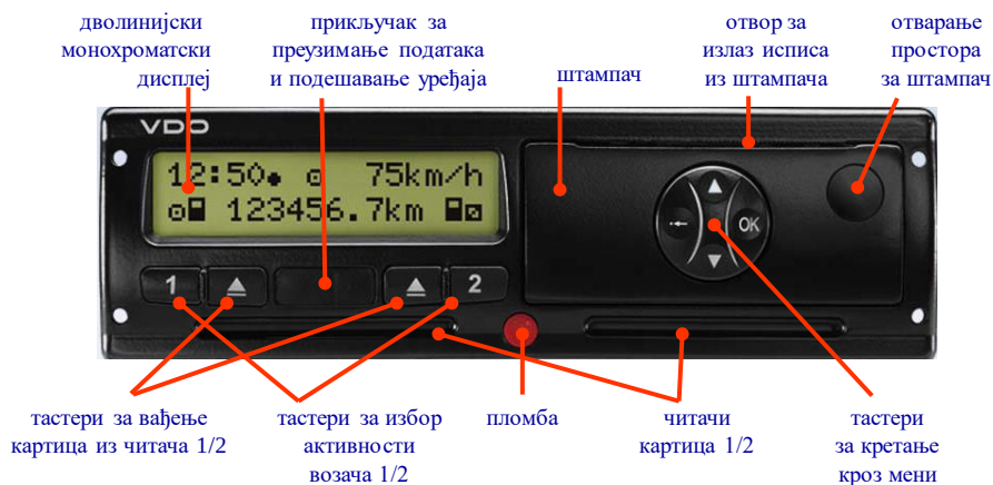
Слика 73 - Компоненте и функције DTCO 1381
