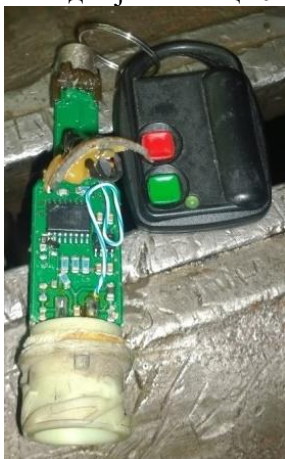
Слика 92 - Прерађени сензори кретања (KITAS) и даљински управљачи
