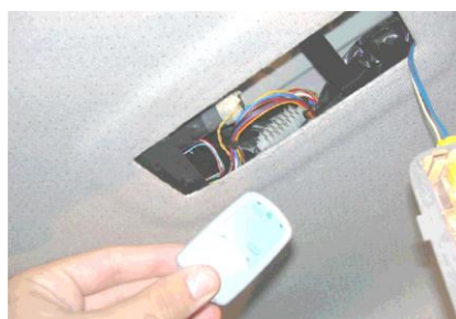
Слика 89 - Манипулација повезивањем другог сензора кретања KITAS
