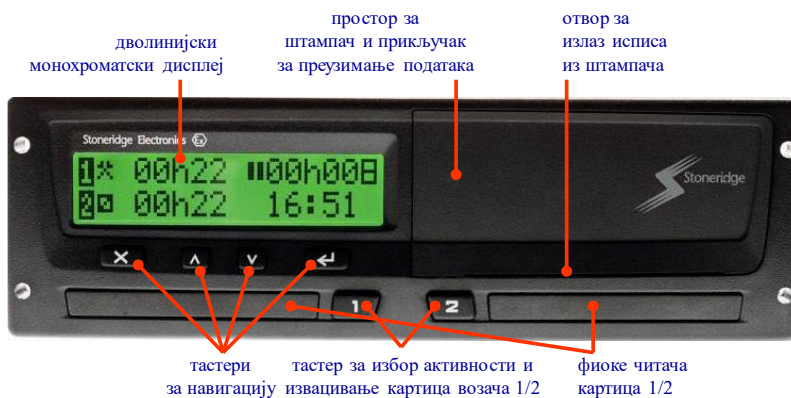
Слика 74 - Компоненте и функције SE5000
