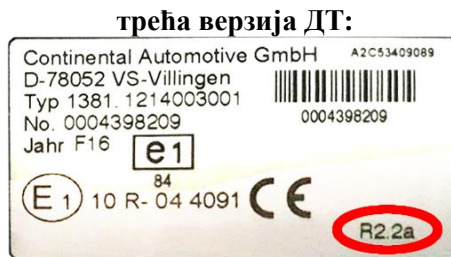
Слика 50 - Различите ознаке серија на натписној плочици (налепници) ДТ прве генерације DTCO 1381
