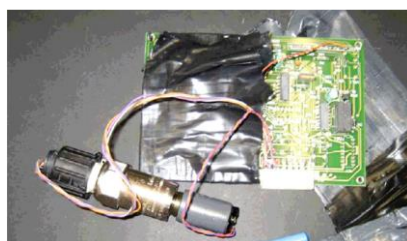
Слика 90 - Пример другог, сакривеног сензора кретања у кабини возила
