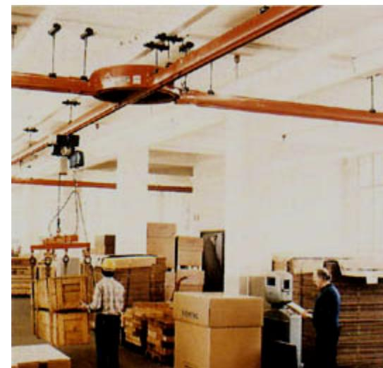
Sredstva za transport i manipulaciju sa cikličnim dejstvom – **VISEĆE PRENOSILICE**
