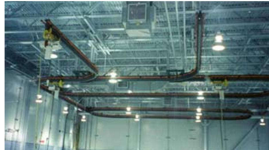
Sredstva za transport i manipulaciju sa cikličnim dejstvom – **VISEĆE PRENOSILICE**
