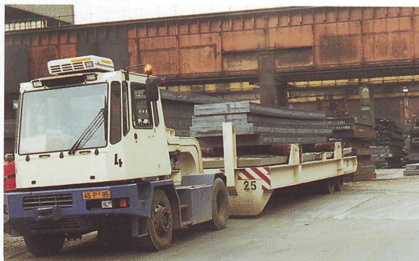
MT 30/MT 36 im Hafeneinsatz mit MAFI-Rolltrailern oder als Zugmaschine für das Kassettensystem.
