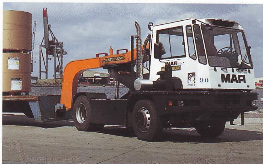
MT 30/MT 36 im Hafeneinsatz mit MAFI-Rolltrailern oder als Zugmaschine für das Kassettensystem.
