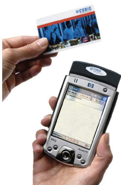
Slika 36. Ručni PDA uređaj za naplatu voznih karata. Vozna karta se takođe može i u vozu kupiti, uz određenu doplatu. Ako kupuje kartu u vozu, putnik istu može platiti novcem ili u ovom slučaju „smart“ karticom. Dizajniran za mobilnu naplatu i kontrolu voznih karata, ovaj uređaj kontroliše, overava ili obrađuje bezkontaktno kartice. Sa opcionim štampačem (uz pojas kontrolora) i Bluetooth bežičnim komunikacijama, ručni PDA uređaj takođe izdaje i klasične papirne vozne karte. Uređaj vrlo brzo čita i potvrđuje da je plaćena vozna karta ili prikazuje podatak na kartici tako da se kontrolor može uveriti da je sačuvana odgovarajuća elektronska vrednost na kartici, ili je vrednost umanjena za cenu konkretne vožnje.
