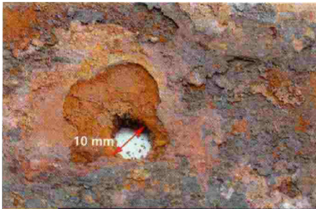
Slika 15. Pojava korozije na unutrašnjem (levo) i spoljašnjem delu (desno) dna čeličnog rezervoara
