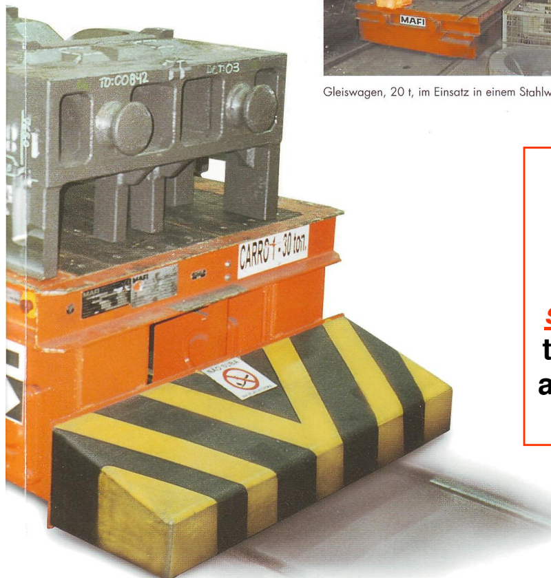
Gleiswagen, 30 t, für Platinentransport
