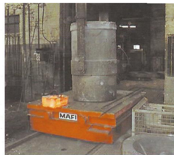
Gleiswagen, 20 t, im Einsatz in einem Stahlwerk
