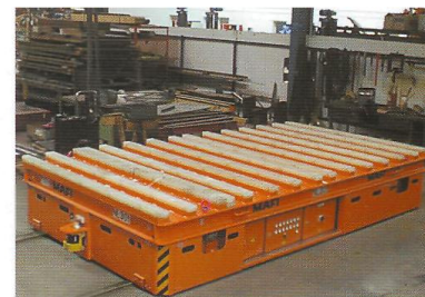
Gleiswagen, 30 t, für Platinentransport
