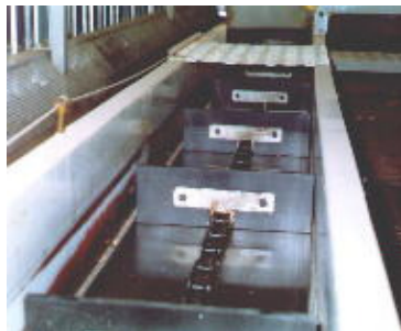
1.Oluk, 2. Vučni lanac, 3. Lopatica, 4. Pogonska zvezda, 5. Zatezna zvezda, 6. Utovar, 7. Istovar
