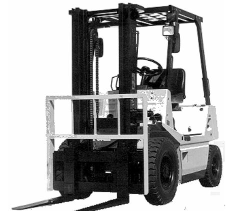
brzina spuštanja opterećenih viljuški, a  $H_o$  [m] visina sa koje se teret spušta. Ukoliko svi podaci o brzinama dizanja ili spuštanja za konkretni viljuškar nisu poznati, usvaja se da je brzina dizanja praznih viljuški oko 30% veća od brzine dizanja sa teretom. Brzina spuštanja
