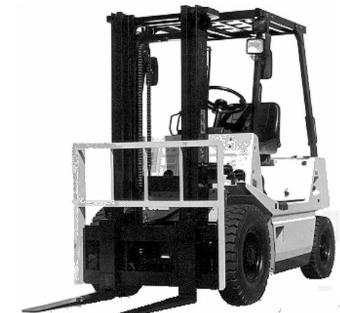
brzina spuštanja opterećenih viljuški, a  $H_o$  [m] visina sa koje se teret spušta. Ukoliko svi podaci o brzinama dizanja ili spuštanja za konkretan viljuškar nisu poznati, usvaja se da je brzina dizanja praznih viljuški oko 30% veća od brzine dizanja sa teretom. Brzina spuštanja tereta je od 50 do 70% veća od brzine dizanja tereta, dok je brzina spuštanja viljuški sa teretom oko dva puta veća od brzine spuštanja neopterećenih viljuški.
