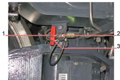
Aktiviranje kočnice sa oprugom u slučaju opasnosti
