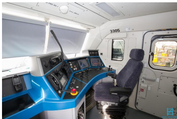
Slika 29: upravljačnica Siemens Vectron višesistemske električne lokomotive
