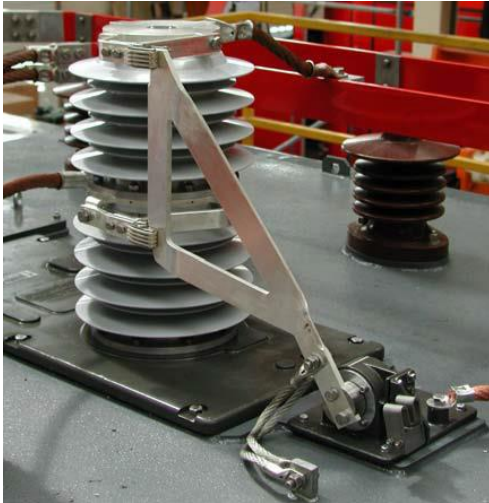
Slika 24:a). AC -glavni prekidač sa rastavljačem; b). DC-glavni prekidač
