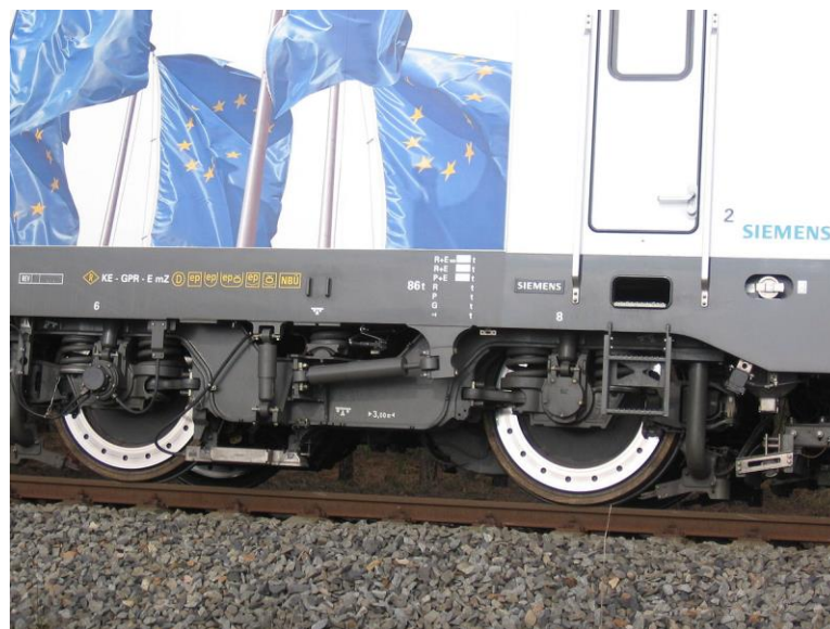
Slika 11: prikaz elastično ogibljenog obrtnog postolja SF4
