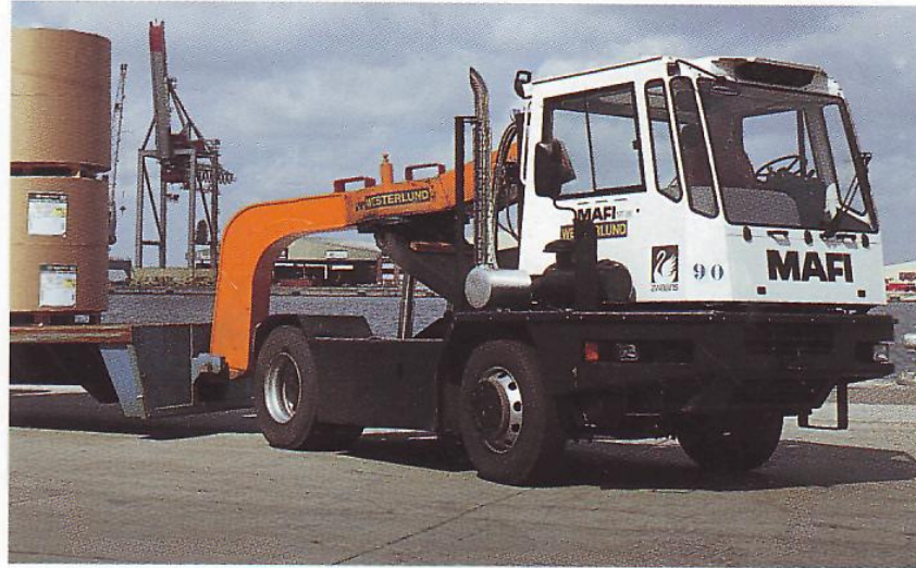
MT 30/MT 36 im Hafeneinsatz mit MAFI-Rolltrailern oder als Zugmaschine für das Kassettensystem.
