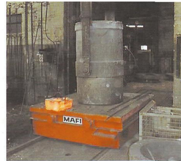
Gleiswagen, 20 t, im Einsatz in einem Stahlwerk
