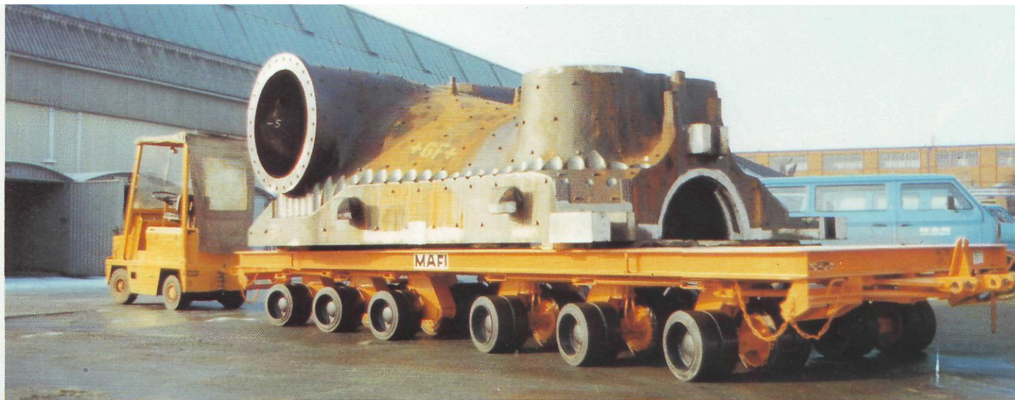
Prikaz međupogonskog transporta pozicije teške više desetina/stotina tona primenom prikolice.
