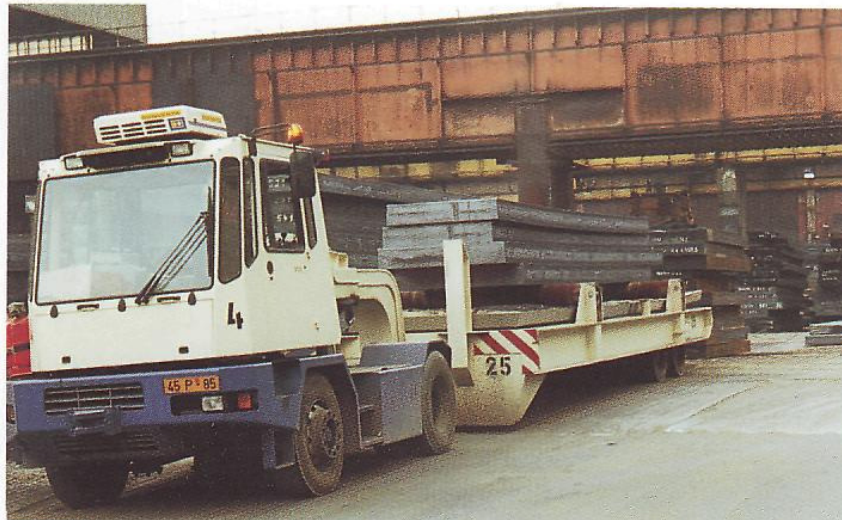
MT 30/MT 36 im Hafeneinsatz mit MAFI-Rolltrailern oder als Zugmaschine für das Kassettensystem.
