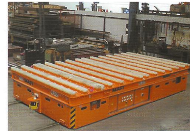
Gleiswagen, 30 t, für Platinentransport
