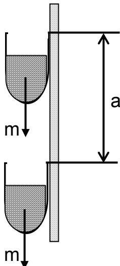
U slučaju premeštanja rasutog tereta vedrima ili kašikama koje su raspoređene na rastojanje a [m] tehničku normu transportnog kapaciteta utvrđujemo preko
